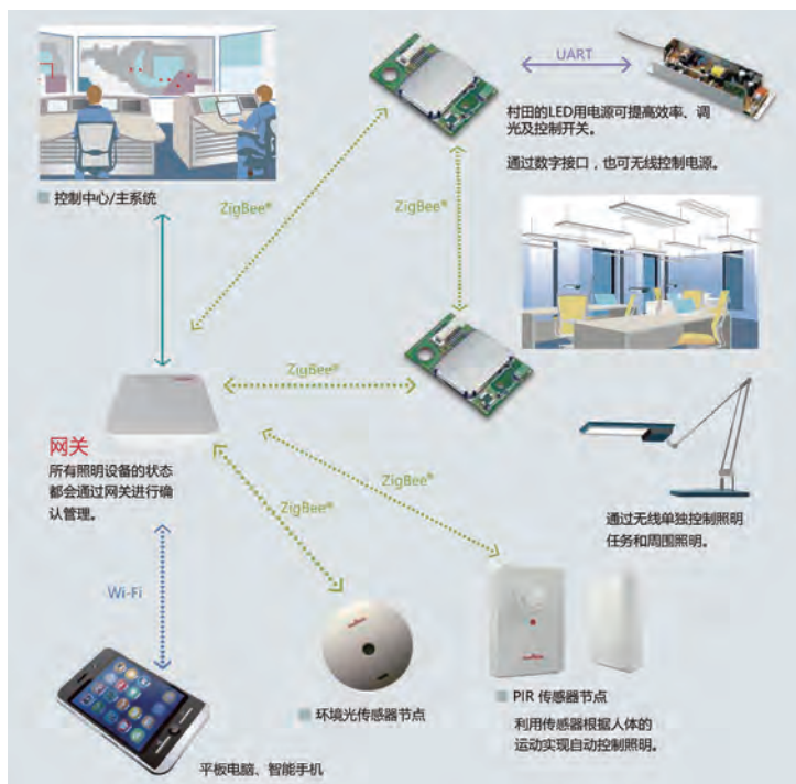
智能照明系统
